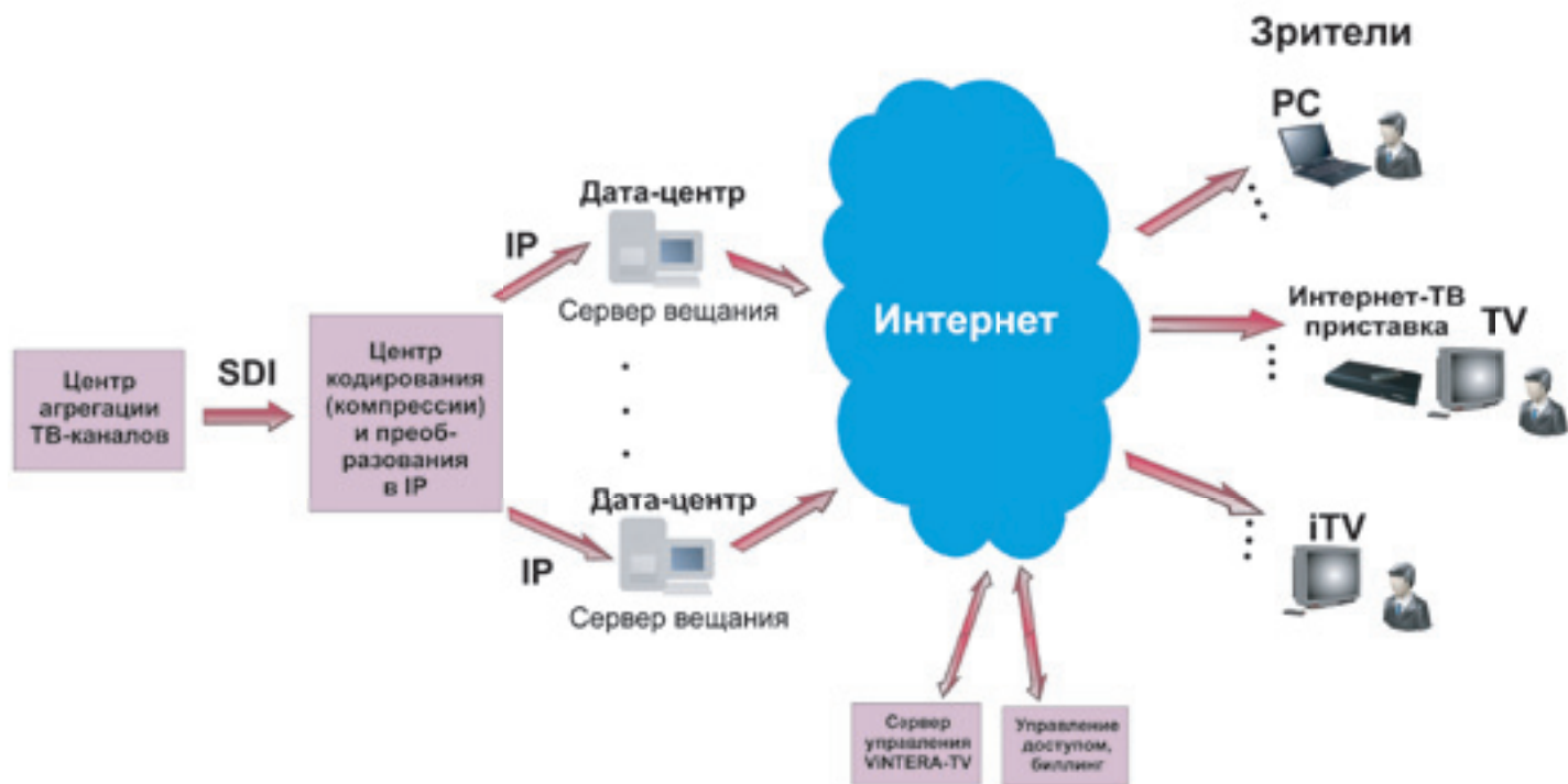
Схема организации вещания Интернет-ТВ ViNTERA-TV
